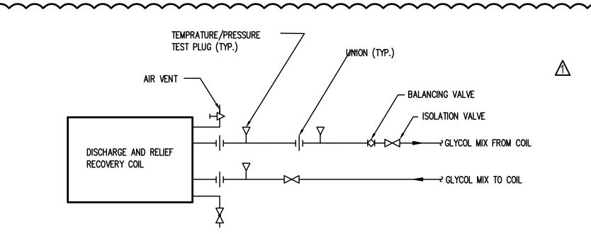
MECHANICAL GLYCOL PUMP CONNECTION DETAIL
