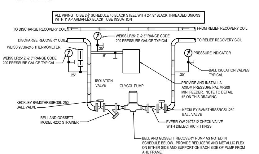
MECHANICAL GLYCOL PUMP CONNECTION DETAIL
