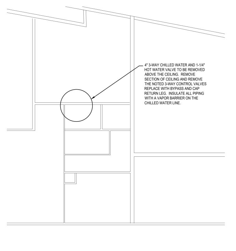
NEW CONTROLLER AT AHU REQUIREMENT
