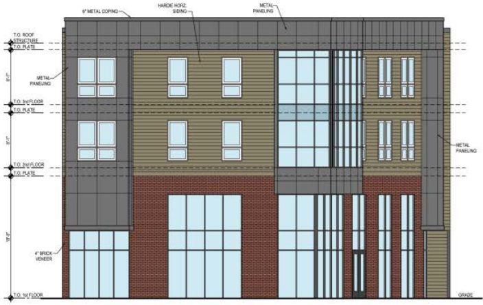
1 FRANKFORD AVE. ELEVATION SCALE: 1/4" = 1'-0" (25X) SCALE: 1/8" = 1'-0" (12.5X)
