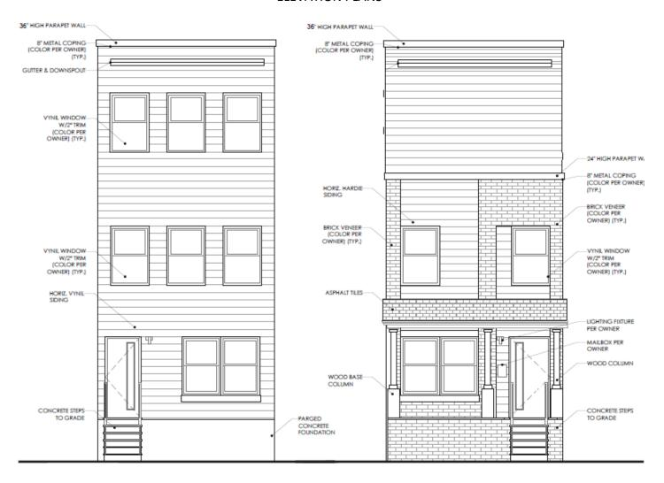
BACK ELEVATION SCALE 1/4" - 1'-0" FRONT ELEVATION
